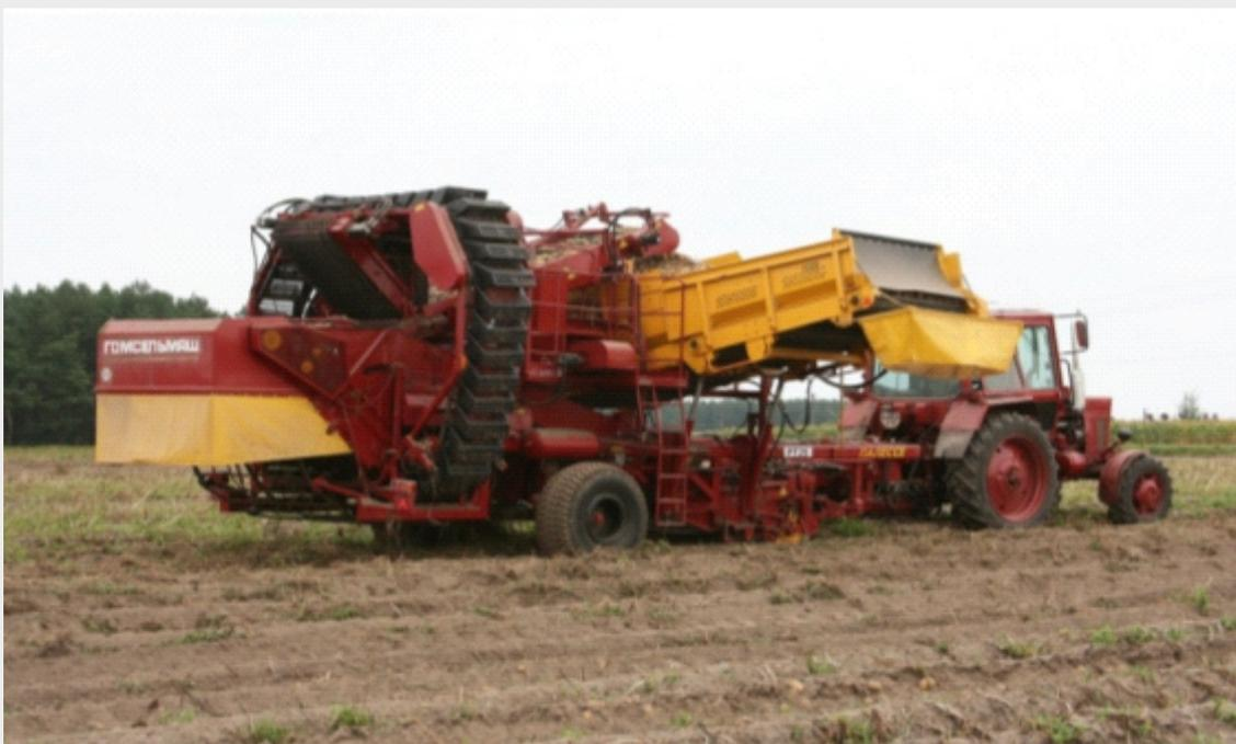
Полуприцепной картофелеуборочный комбайн ПАЛЕССЕ RT25 с бункером и переборочным столом предназначен для уборки картофеля на гребневых посадках с междурядьями 70-75 см или 90 см на легких и средних почвах в зонах возделывания картофеля с умеренным климатом, кроме горных, с предельным уклоном полей не более 4°.
