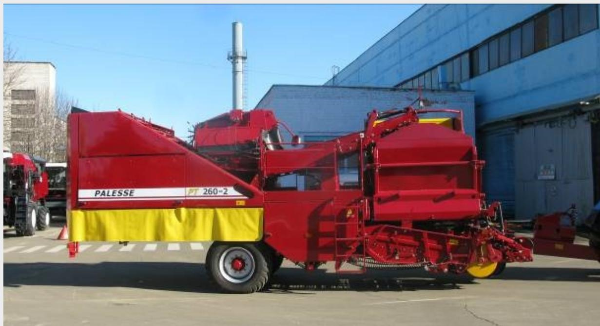
Полуприцепной картофелеуборочный комбайн с боковым подкопом картофельных гребней КПБ-260-2 «ПАЛЕССЕ РТ 260-2» с третьим сепарирующим устройством для отделения комков предназначен для уборки картофеля на гребневых посадках с междурядьями 70 - 75 см или 90 см на легких, средних и тяжелых почвах с наличием комков и содержанием в просеиваемой почве камней размером не более 100 мм в количестве не более 15 % к массе картофеля в зонах возделывания картофеля с умеренным климатом, кроме горных.
